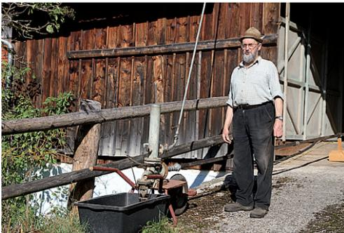
Bis vor wenigen Jahren sicherte dieser Widder die Wasserversorgung der Wolfratshäuser Hütte am Grubigstein bei Lermoos. Der „Schorsch“ hat in vielen Stunden dieses Gerät dahingehend mit Anschlüssen versehen, dass es zu Demonstrationszwecken in Betrieb genommen werden kann. Sehen
