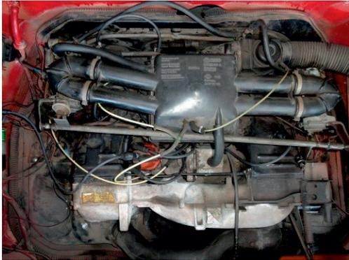
Mein Motor ist (wie beim T2) wieder längs im Heck angeordnet. Dieses Konzept war zwar bereits beim Erscheinen des T3 überholt, weil so immer noch keine durchgehende Ladefläche zur Verfügung gestellt werden konnte. Zu Beginn standen eh nur zwei luftgekühlte Boxermotoren (Ottomotoren mit 50PS und 70PS) zur Wahl, die mit wartungsfreien Hydrostößeln und einer kontaktlosen
