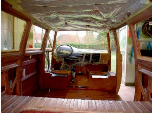
aber noch nicht nutzen müssen... Die Korrosionsvorsorge war jedoch nur zufriedenstellend; noch im Modelljahr 1989 gab es den Dauerunterbodenschutz auf Wachs-Bitumen-Basis ab Werk nur für 400 DM extra. Mein größtes T3 Problem ist die Fugenkorrosion, vor allem bei den aus mehreren Blechen zusammengesetzten Karosserie-Seitenwänden.
